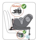
**4.** Drücken Sie auf einen ISOFIX Konnektor, um ihn mit einem Klickgeräusch mit der ISOFIX-Verankerung zu verbinden. Wiederholen Sie den Vorgang auf der anderen Seite, um beide ISOFIX-Konnektoren zu verriegeln.
