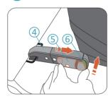
1. Drücken Sie den ISOFIX-Anzeigeknopf 6 und drücken Sie die ISOFIX-Verriegelungstaste (5), um den ISOFIX-Konnektor 4) freizugeben. Diese Tätigkeit muss durchgeführt werden, um beide ISOFIX-Konnektoren zu lösen. Jetzt können Sie den Kindersitz von Ihrem Fahrzeugsitz entfernen.
