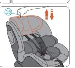
Ziehen und halten Sie den Einstellring der Kopfstütze 16 . um die Kopfstütze 1 freizugeben. Ziehen Sie den Ring nach oben, um die Kopfstütze in höhere Positionen zu bringen. Halten Sie den Ring fest und drücken Sie die Kopfstütze nach unten, um die Kopfstütze in niedrigere Positionen zu bewegen. Wenn sich die Kopfstütze in der gewünschten Position befindet, lassen Sie den Ring los, um die Kopfstütze zu verriegeln.
