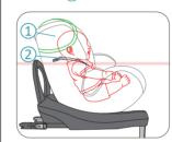
**▲ GEFAHR** Wenn der Kindersitz in Fahrtrichtung verwendet wird, muss die Kopfstütze so eingestellt werden, dass sich die Schultergurte des 5-Punkt-Gurts auf gleicher Höhe oder knapp über den Schultern des Kindes befinden.
