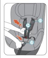
**1.** Halten Sie die Taste zum Einstellen des Gurtes (13) gedrückt und ziehen Sie den Schultergurt 24)so weit wie möglich zu sich heran. Vergewissern Sie sich, dass Sie den Schultergurt wie abgebildet unter den Brustpolstern (15) herausziehen.
