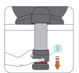
6. Drücken Sie den Stützfuß-Auslöseknopf 8 , um den Stützfuß 9 freizugeben, bis er den Fahrzeugboden berührt.
