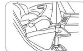
Passen Sie nach der Installation des Autositzes auf der Installationsplatte die Höhe der Fußplatte und der Stützfuß an den Komfort Ihres Kindes an.
