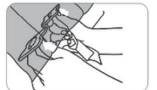
Schieben Sie die Installationsclips so weit wie möglich hinein. Drücken Sie fest zu und stellen Sie sie aufrecht. Wenn Sie die Clips nicht aufrichten können, drücken Sie die Installationsclips weiter nach unten.
