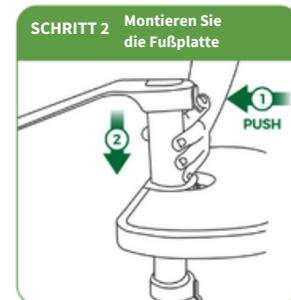
Halten Sie die Taste der Installationsplatte gedrückt und stecken sie die Platte von oben auf die Höhenkontrollstange.
