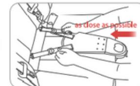
Platzieren Sie die Höhenkontrollstange nah am Fahrzeugsitz und ziehen Sie die Gurte fest. Stellen Sie die Gurte so ein, dass die Platte eng am Sitz anliegt. Die Fußplatte kann wackeln, wenn sie nicht fest genug sitzt.
