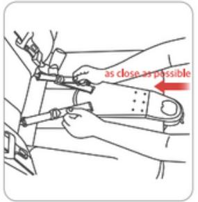
Platzieren Sie die Höhenkontrollstange nahe am Fahrzeugsitz und befestigen Sie die Gurte. Passen Sie die Gurte so an, dass die Installationsplatte eng am Sitz anliegt (siehe Abbildung).
