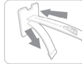
Halten Sie den Gurt mit dem eingravierten Logo nach oben. Führen Sie den Gurt in die obere Öffnung des Installationsclips ein und ziehen Sie ihn dann durch die untere Öffnung heraus
