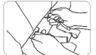
Hängen Sie die Installationsclips, wie in der Darstellung gezeigt, in die Öffnung. Drücken Sie die Clips nach unten, für eine leichtere Installation.
