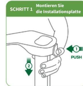
Halten Sie die Höhenkontrollknopf der Installationsplatte gedrückt und stecken Sie die höhenverstellbare Kontrollstange.
