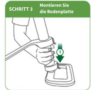
Setzen Sie die Bodenplatte unter der Fußstütze ein. (Stützfuß und Höhenkontrollstange werden vormontiert geliefert).
