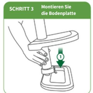
Installieren Sie die Bodenplatte unter dem Stützfuß. (Stützfuß und Höhenkontrollstange werden vormontiert geliefert)
