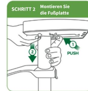
Halten Sie die Taste der Fußplatte gedrückt und stecken Sie die Fußplatte von oben nach unten auf die Höhenkontrollstange.
