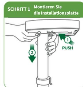
Halten Sie den Höhenkontrollknopf der Bodenplatte gedrückt und stecken Sie die Bodenplatte von oben auf die Höhenkontrollstange.
