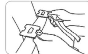
Halten Sie die Installationsclips horizontal und hängen Sie sie in den Gurt ein.
