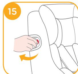
2. Osłona przed uderzeniami bocznymi naprzeciwko drzwi pojazdu może być zamknięta w celu zwiększenia ilości miejsca do siedzenia, jeżeli konieczne. Strona bliżej zewnętrza pojazdu powinna być zawsze w położeniu otwartym. **16**
