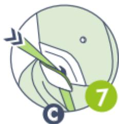
**7** Ziehen Sie den Dreipunktgurt heraus und führen Sie den oberen Teil des Gurtes durch die Schultergurtführung (C) über die grüne Gurtverlaufsanzeige. Vergewissern Sie sich, dass die Gurtführung wieder geschlossen ist und das Band nicht verdreht ist.
