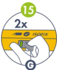
**15** Öffnen Sie die ISOFIX-Konnektoren, indem Sie an dem ISOFIX-Entriegelungshebel (G) direkt an der Seite der Konnektoren ziehen.
