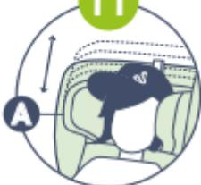
**11** Bewegen Sie die Kopfstütze (A) und schieben Sie sie nach oben oder unten. Stellen Sie die Kopfstütze so ein, dass der Eye-Level Indikator auf Augenhöhe Ihres Kindes ist oder dass nicht mehr als zwei Finger (ca. 2 cm) zwischen die Schulter Ihres Kindes und die Unterkante der Kopfstütze passen.
