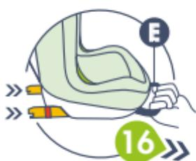
**16** Schieben Sie die ISOFIX-Konnektoren zurück in den Sitz, während Sie am Band an der Vorderseite ziehen (**E**). Nehmen Sie den Sitz dann aus dem Fahrzeug.
