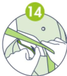
**14** Drücken Sie den Verriegelungsmechanismus der Schultergurtführung (G) nach innen und schieben Sie den Dreipunktgurt aus der Gurtführung.
