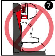
**! Der Beckenteil eines Dreipunktgurtes MUSS niedrig und eng über die Hüften anliegen, wobei das Becken festgehalten wird und die Oberschenkel des Kindes kaum berührt werden sollten. Der Beckenteil DARF NICHT über den Bauch des Kindes geführt werden, da dies in scharfen Kurven, beim plötzlichen Anhalten oder bei einem Unfall zu schweren Verletzungen des Kindes führen kann.**
