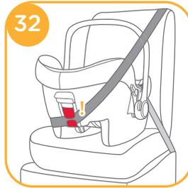
3. Ziehen Sie am Schultergurt des Fahrzeugs, um das Babyschalenmodul fest und sicher zu verankern. <sup>33</sup>
