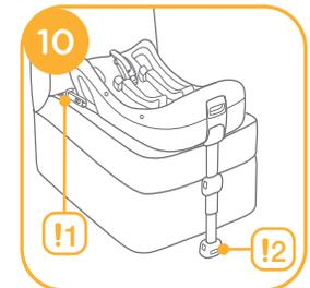
6. Drücken Sie das Babyschalenmodul herunter und in die Basis hinein **11**, und ist das Rückhaltesystem für Kleinkinder sicher befestigt, ist die Anzeige des Rückhaltesystems für Kleinkinder grün. **12**
