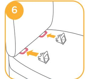
3. Drehen Sie die ISOFIX-Befestigungen um 180 Grad, bis sie in Richtung ISOFIX-Führungen zeigen. 7
