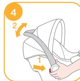
Druk om het handvat in te stellen op de handvatknoppen aan weerskanten om het vrij te geven 4 -1, en draai het handvat vervolgens tot het in een van de drie standen klikt. 4 -2
