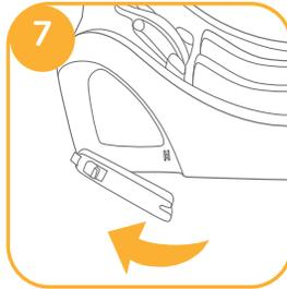
4. Richten Sie die ISOFIX-Befestigungen mit den ISOFIX-Führungen aus und stecken Sie dann beide ISOFIX-Befestigungen bis zum Einrasten in die ISOFIX-Verankerungspunkte. 8
